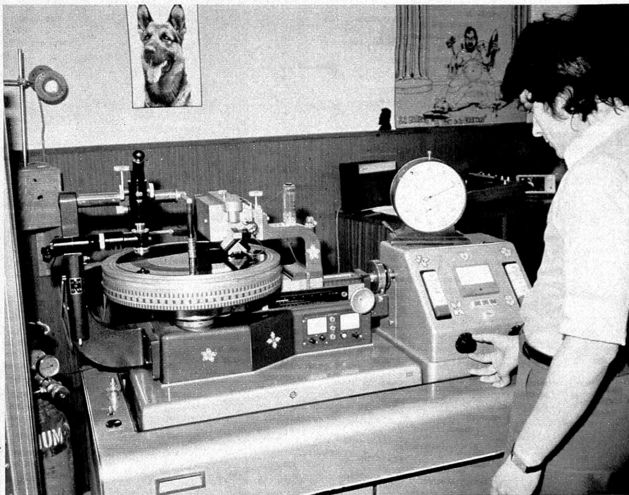
La machine de gravure transfère sur la laque nitrocellulosique du disque original l'enregistre-
