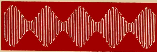
Oscillogramme d'un son de battement. L'intensité varie périodiquement, à une fréquence égale à la différence de celles des deux sons.
