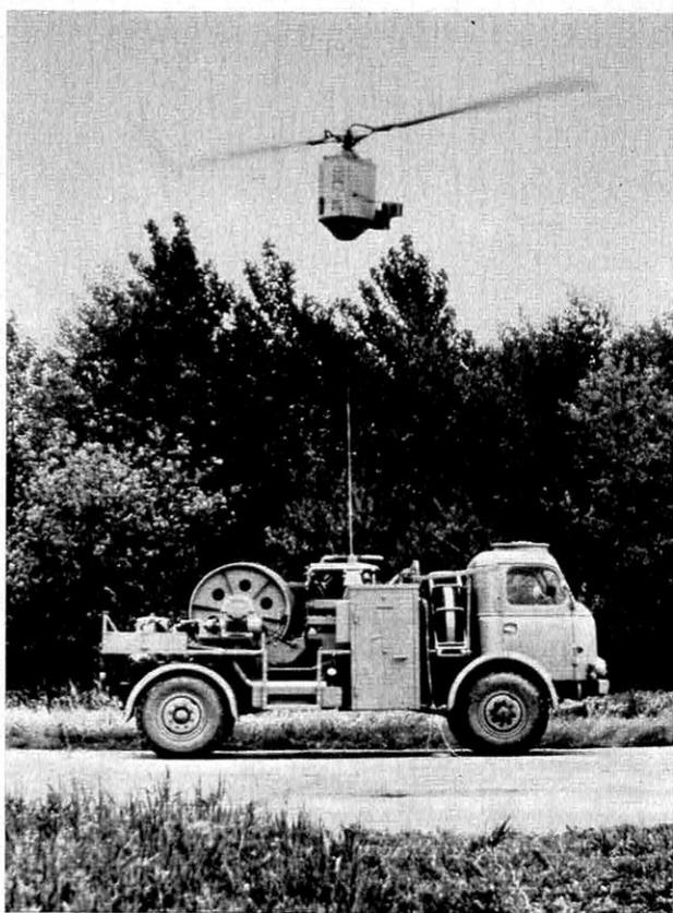
Deux engins télécommandés nés en Allemagne fédérale à la suite des travaux de Dornier. En haut, l'Aérodyne, qui comprend une manche à écoulement avec soufflante. Des volets disposés à l'extrémité de la manche permettent la déflexion du jet de la verticale à l'horizontale. La soufflante est entraînée par une turbine à gaz dont l'échappement sert au contrôle en lacet et en tangage. En bas, la plate-forme Kiebitz, qui est entraînée par un rotor à réaction alimenté en air comprimé. Le diamètre du rotor atteint 8 m.
