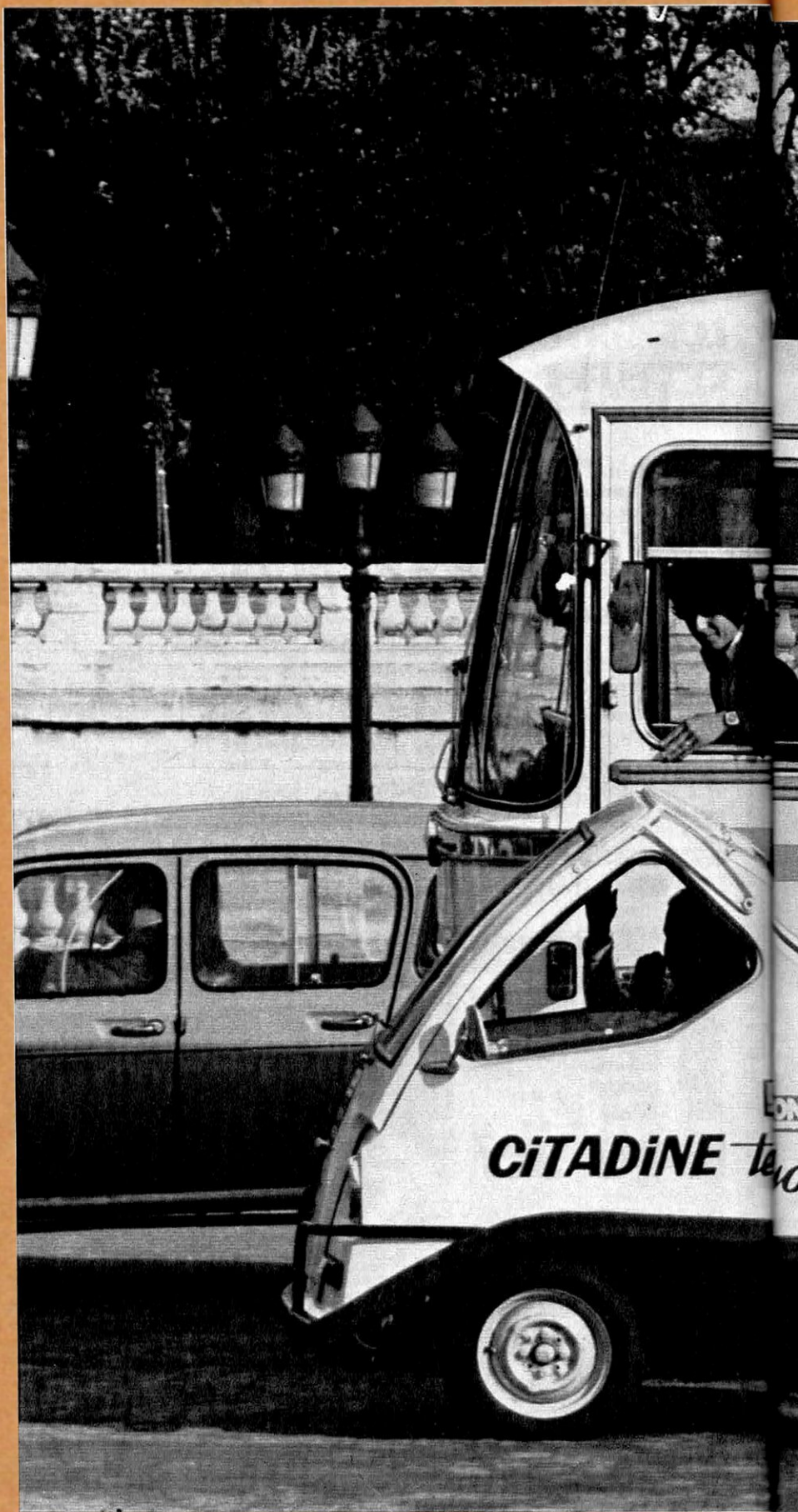
La Citadine, 8 batteries 12 V, moteur 4 kW, est construite en série depuis
