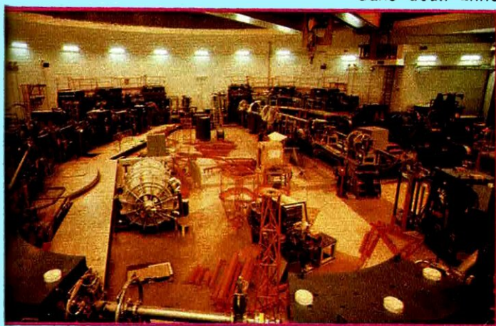
B) Les deux anneaux de stockage se situent dans « l'igloo », bâtiment circulaire de 60 m de diamètre (à droite). L'ensemble de ces deux anneaux superposés apparaît avec, au premier plan, deux des électro-aimants (représentés par un enroulement spiralé sur le schéma) et les électrons circulent pendant des heures dans un tuyau de dix centimètres de diamètre. (à gauche).
