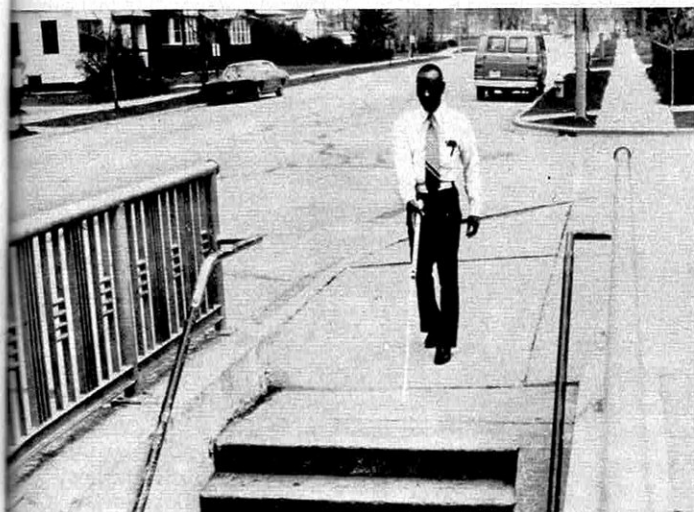
La « Canne-laser » : une triangulation optique
