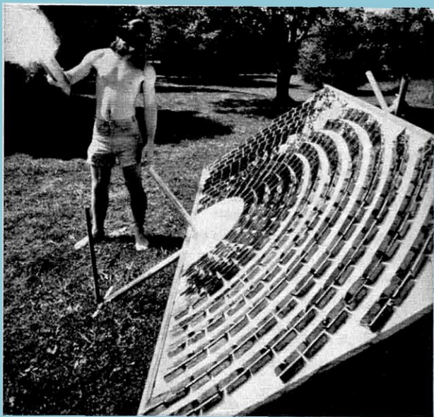
E. Barhart, le technicien de l'équipe du New Alchemy Institute, expérimente un four solaire composite constitué d'un assemblage de miroirs individuels.
