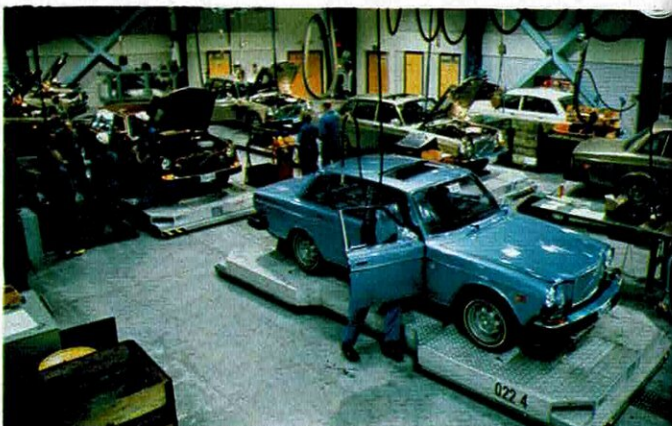
8 Dans chaque atelier, la chaîne peut être mise en ligne ou en parallèle comme ici.
