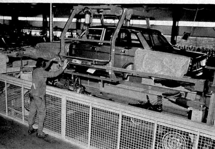
1 Au 1 er étage, la carrosserie équipée est déposée sur un chariot « haut » montant du rez-de-chaussée.
