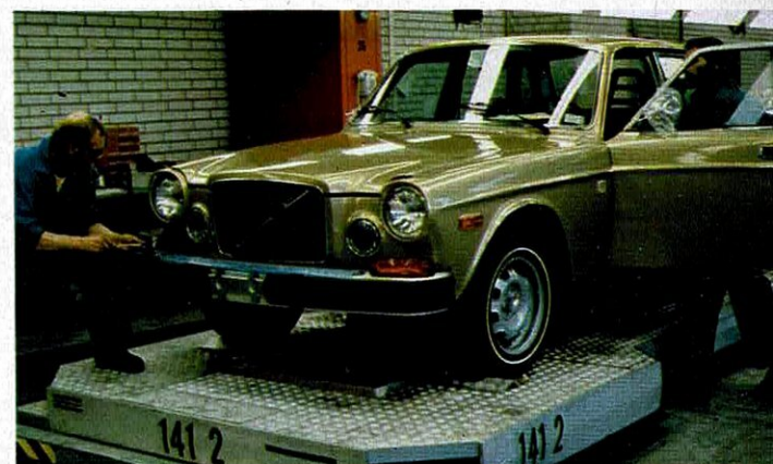
10 L'assemblage est terminé. La voiture va être descendue du chariot « bas ».
