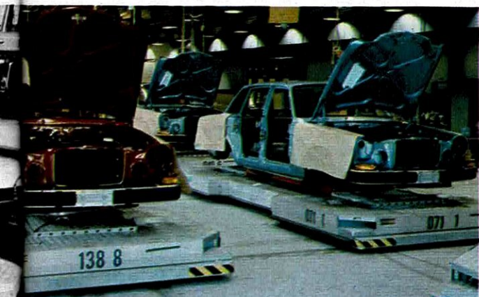
7 Pour chaque voiture, l'ordinateur délivre une feuille de contrôle nécessaire au montage.
