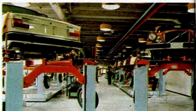
1 Le flux des chariots est réglé par des « boucles » de régulation.
