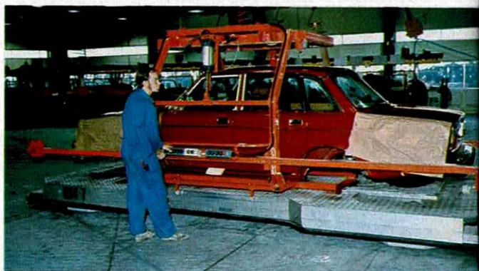
1 Les carrosseries qui arrivent de Göteborg sont montées sur un chiot « bas ».
