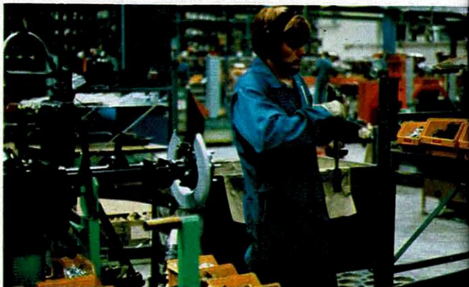
3 La chaîne est bordée d'ateliers de pré-montage qui s'approvisionnent dans le stock central.
