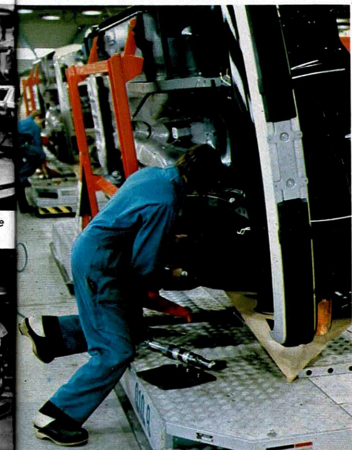
6 Les chariots « bas » présentent les carrosseries dans une position commode pour le travail.
