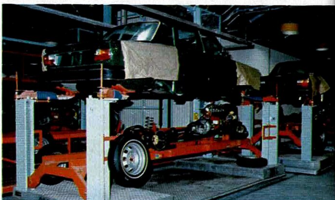
5 Le bloc moteur et le pont sont montés sur des chariots « hauts » qui reçoivent les carrosseries.
