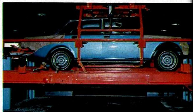
4 L'ordinateur régule le déchargement des voitures en fonction du flux de chariots.
