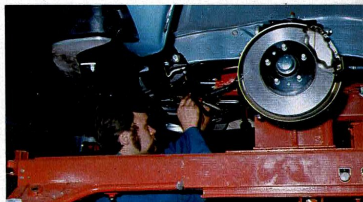
7 Le bloc moteur et le châssis sont montés sur les chariots « hauts » pour être fixés à la carrosserie.
