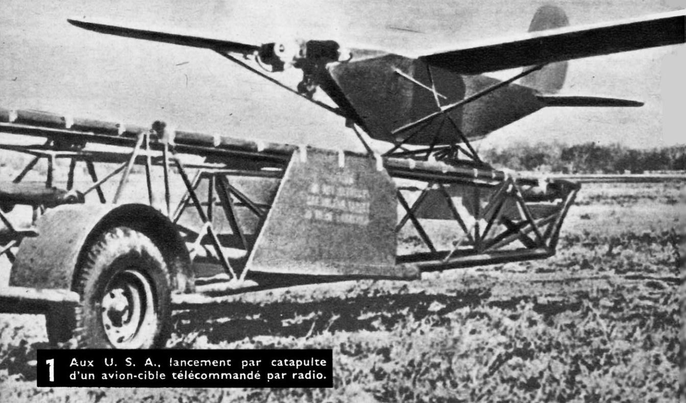
**1** Aux U. S. A., lancement par catapulte d'un avion-cible télécommandé par radio.
