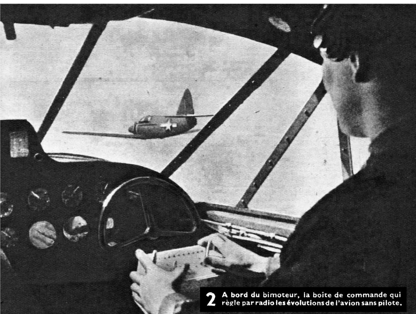
**2** A bord du bimoteur, la boîte de commande qui règle par radio les évolutions de l'avion sans pilote.
