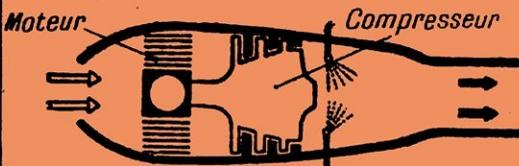
**MOTORÉACTEUR**. Compresseur entraîné par moteur alternatif (Caproni.)
