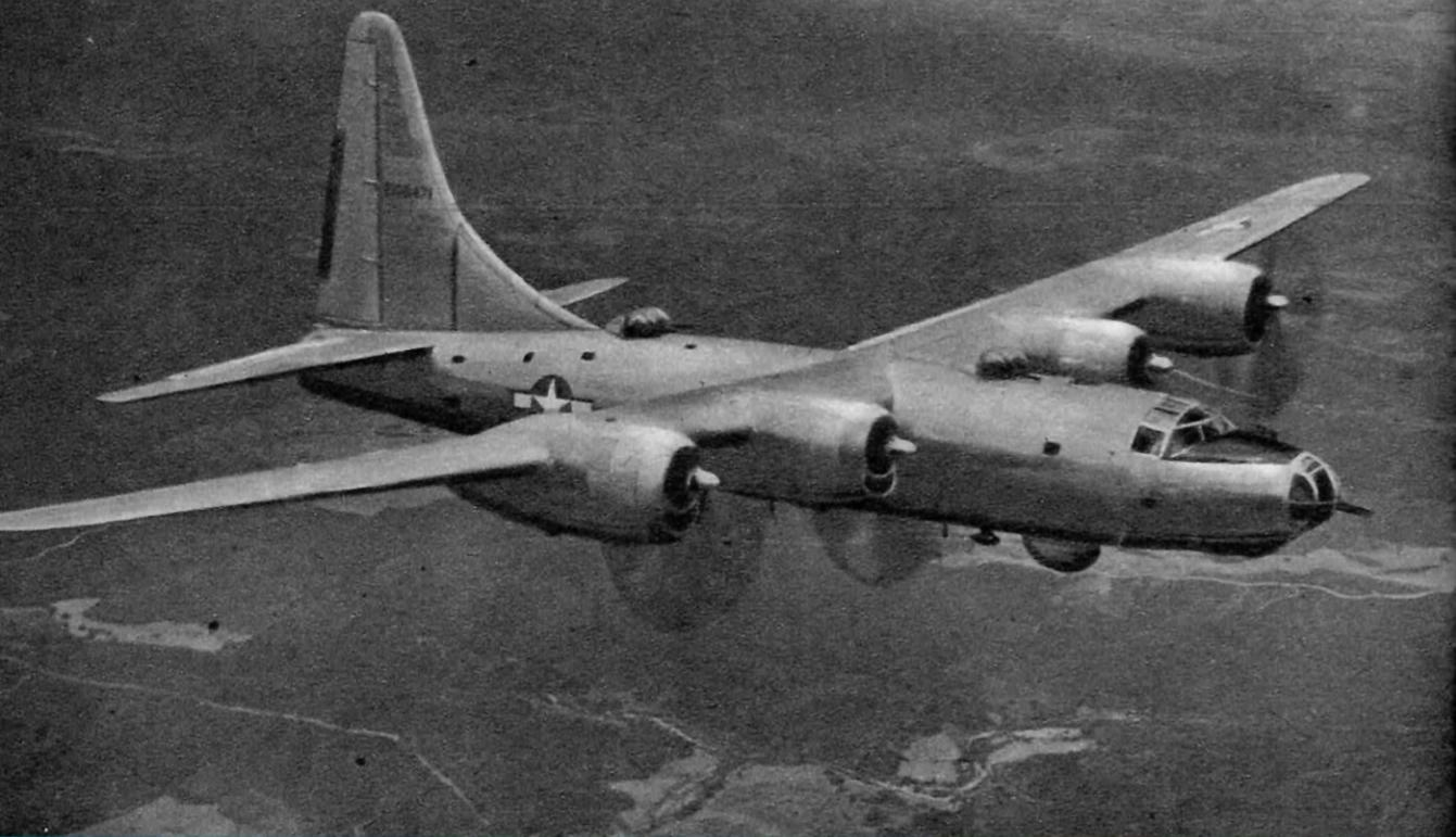
**CONSOLIDATED B-32 « DOMINATOR »** — Du même programme que les « Superfortress », il réclama une mise au point plus longue et ne fit que quelques sorties de guerre contre le Japon. Il s'en distingue par l'abandon de la télécommande des tourelles et de la cabine sous pression.
