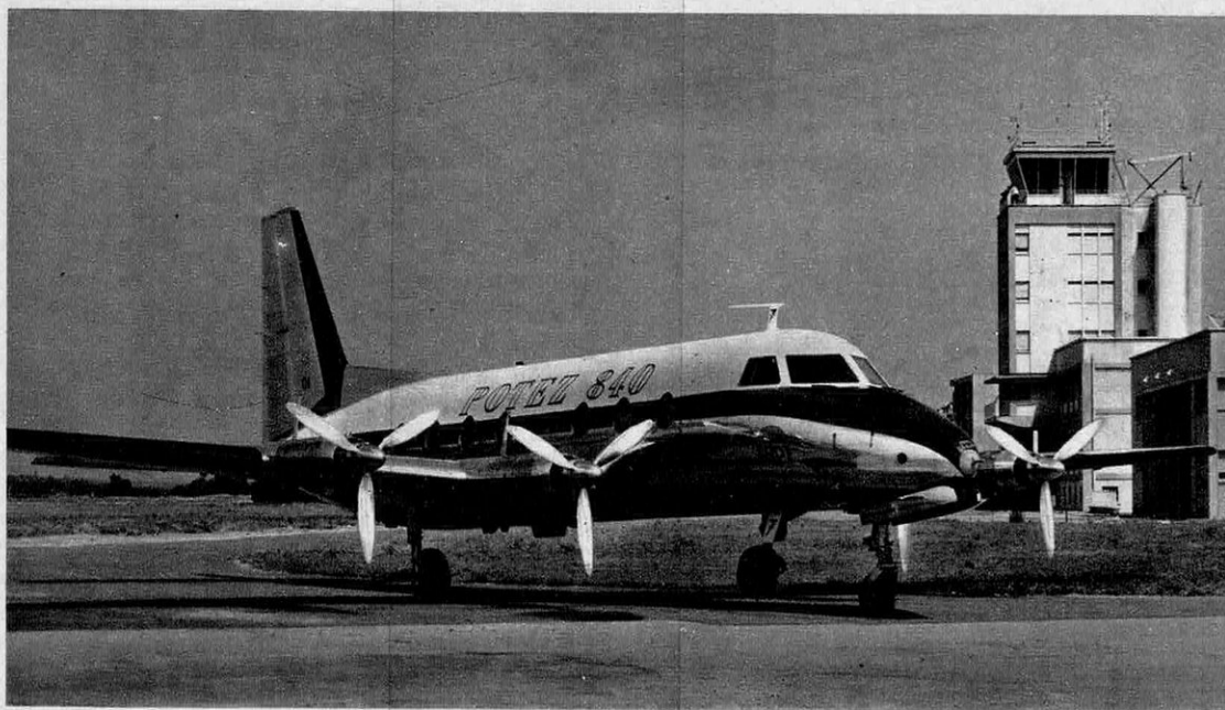
Le Potez 840, quadriturbopropulseur, 8 500 kg en charge, 16 à 24 passagers.
