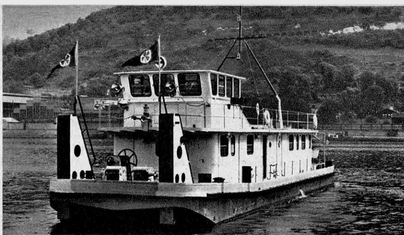
Butoirs à l'avant, poste de pilotage surélevé, propulsés par deux hélices, ces deux pousseurs, américain (à gauche) et français (ci-dessus) sont identiques.
