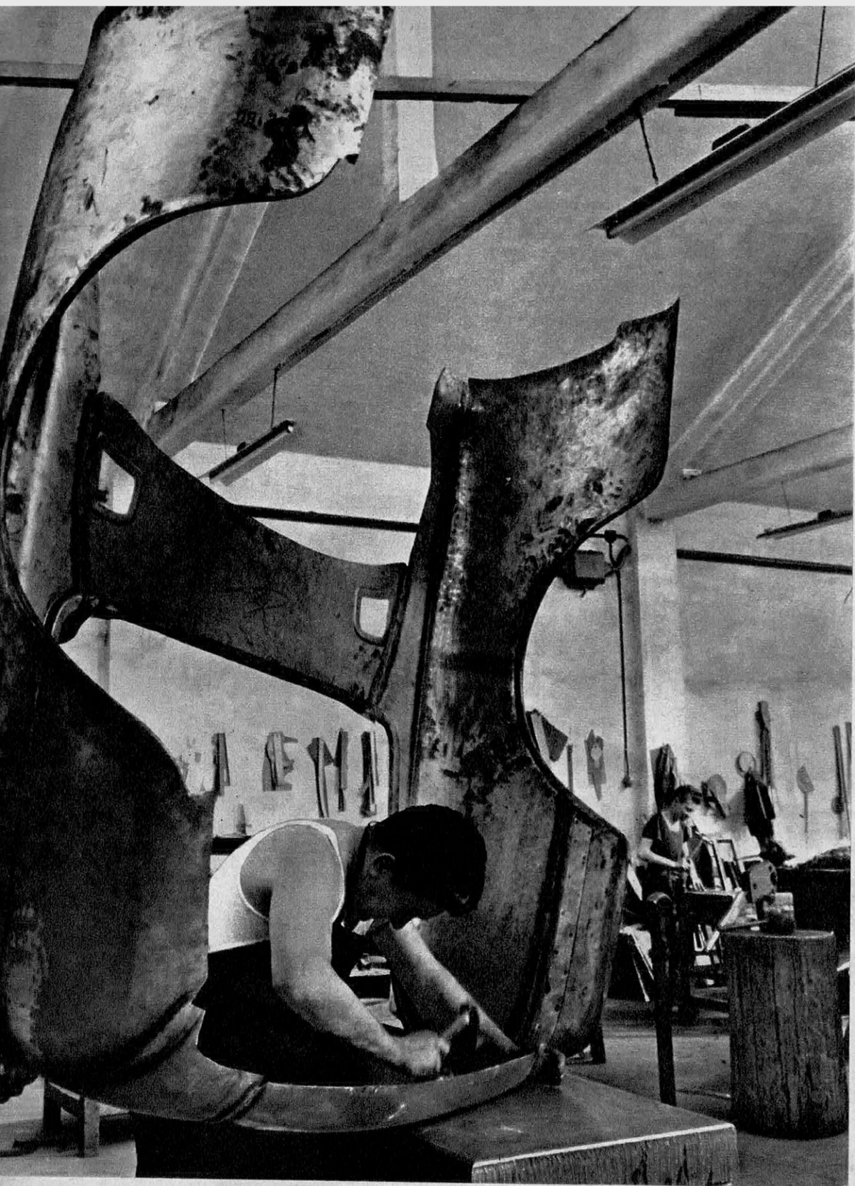
A l'atelier de tôlerie, les prototypes sont faits entièrement au marteau.
