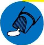
**DOSAGE DU DÉBIT** - A volonté, la pression des doigts sur le flacon flexible FLEXA, permet de faire des points, des gouttes ou une nappe de colle.
