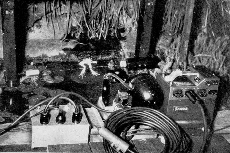
L'équipement du photographe : la grenouille en sautant (A) coupe le rayon (BB) et agit sur l'appareil électronique (C) qui commande (D) la caméra (E) et le flash (F). En (G), la batterie et en (H), un interrupteur.
