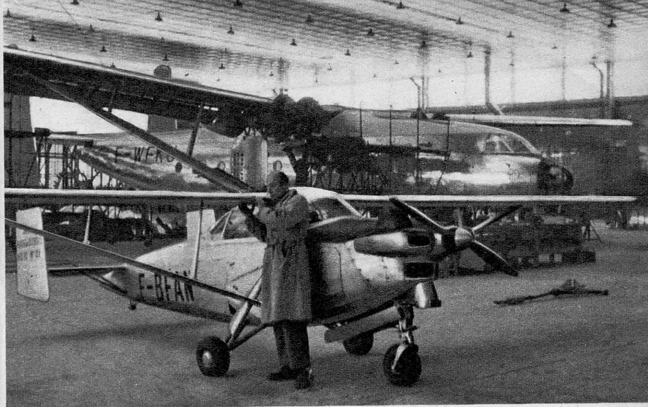
(ph. à dr.). C'est sur ce prototype que M. Hurel démontra les qualités de l'aile à grand allongement haubanée.
