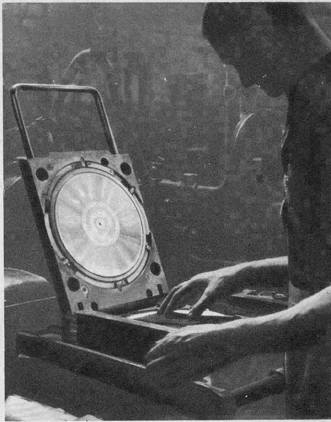
● Chauffé à 150° C ce plateau presseur produit soixante disques en série à l'heure (Pathé Marconi). La même matrice peut faire environ 5 000 disques.
