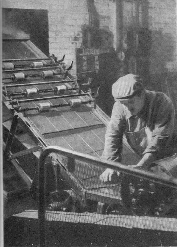
● Les cylindres chauds de la calandre tracent et préparent des zones d'amincissement rectangulaires qui permettent de diviser la pâte en galettes.
