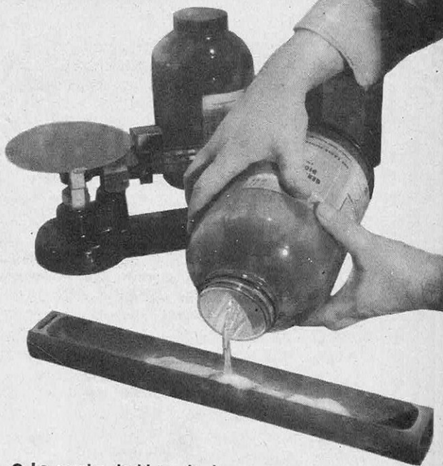
● La poudre de bi-oxyle de germanium est versée dans un moule.
