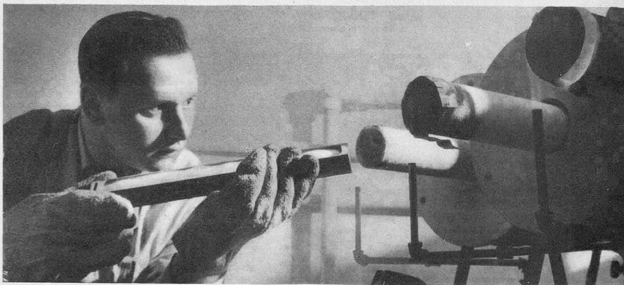
● La poudre est traitée par l'hydrogène dans des fours spéciaux à 650° C. Le lingot est ensuite purifié par refonte à 950° C, et cristallisé. Le germanium ainsi obtenu renferme moins de 1/10 000 d'impureté.
