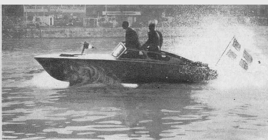
L' « AQUAVIT 4 » de l'International Aquavion présenté en essais sur la Seine, au Salon Nautique d'octobre 1950. Ayant été construit en Suède, il bat pavillon Suédois. Poids : 620 kg en ordre de marche. Longueur 5,8 m. Capacité : quatre, cinq passagers. Puissance : 35 chevaux. Vitesse maximum : 27 nœuds.
