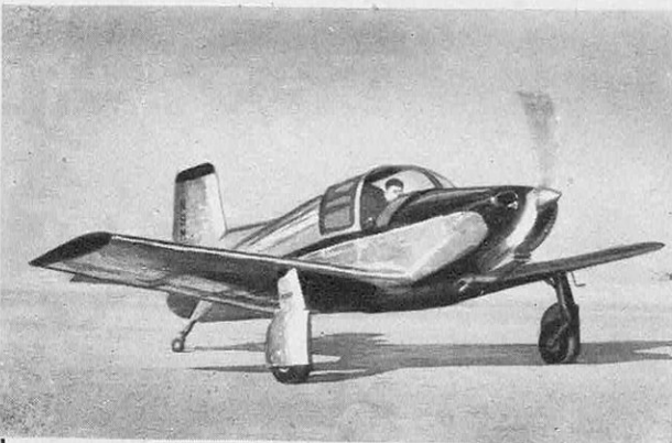
LE MAC KINNIE 165, biplace américain de tourisme, est aussi utilisé par l'armée. Il pèse en charge 775 kg et sa vitesse de croisière est de 288 km/h. Très maniable, il est équipé d'un train d'atterrissage escamotable.
