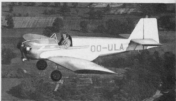
LE FAIREY JUNIOR , monoplace anglais, permettant toutes les acrobaties, pèse un peu plus de 200 kg. Il est équipé soit d'un moteur JAP de 40 ch, soit d'un Walter Mikron de 60 ch. Les ailes et le fuselage sont en bois et entoilés.
