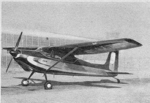
LE CESSNA 180 , quadriplace américain, est capable d'enlever, outre ses quatre passagers, une cinquantaine de kg de bagages. Vitesse de croisière : 240 km/h ; autonomie de vol : 4 heures et demie ; prix : 4 millions.
