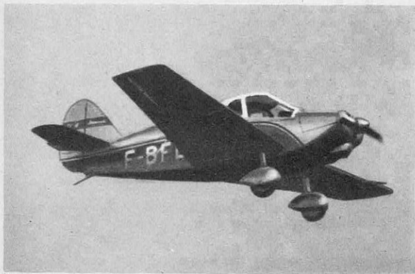
LE BIPLACE MINICAB , petit appareil français de 65 ch, aux qualités de vol remarquables, pèse à vide 266 kg et peut emporter une charge de 200 kg. Il atteint une vitesse maximum de 198 km/h et, en croisière, de 175 km/h.
