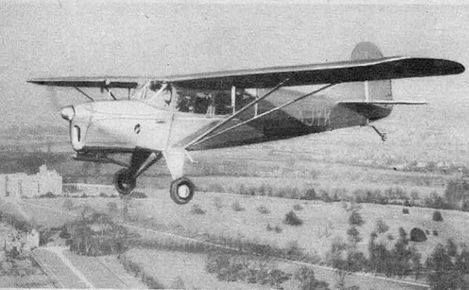
L'AUSTER J 5 B AUTOCAR , avion de tourisme britannique, peut transporter trois passagers en plus du pilote. Il coûte le prix d'une automobile de sport et dépense la même quantité d'essence (18 l aux 100 km environ).
