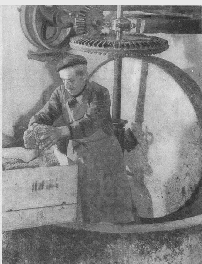
● Depuis que l'industrie du parfum existe, des meules semblables à celle-ci ont écrasé fleurs, graines, écorces et branches.
