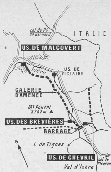
● L'usine de Malgovert (dont ci-contre la position géographique) est alimentée par deux conduites forcées de 2,1 à 2,2 m de diamètre.
