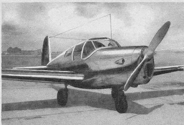
LE SAAB 91 SAFIR , appareil suédois, peut porter 415 kg de chargement. Il fit son premier vol en novembre 1945. Sa vitesse maximum est de 265 km/h, celle de croisière 235 km/h ; son rayon d'action atteint 940 km.
