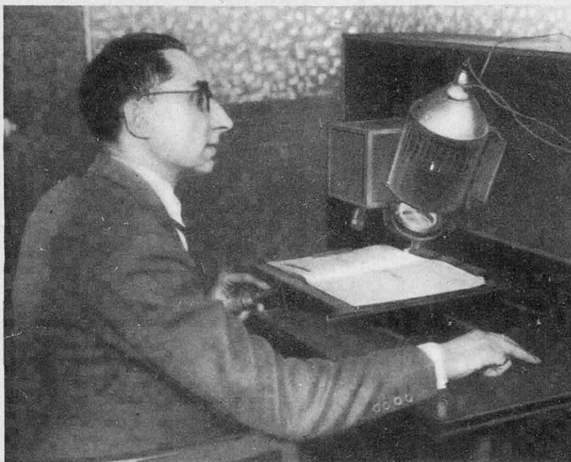
PHOTOÉLECTROGRAPHE THOMAS POUR LA LECTURE DE L'IMPRIMÉ NORMAL
