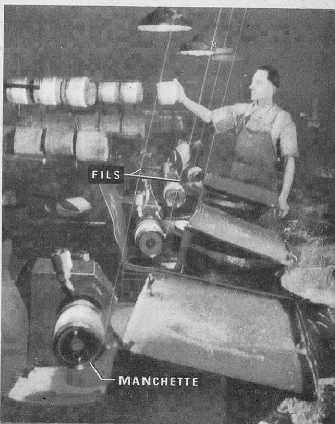
● A l'étage inférieur, le fil formé par l'association des cent brins élémentaires s'enroule sur un tambour d'entraînement qui tourne à la vitesse de 10 000 t/mn.
