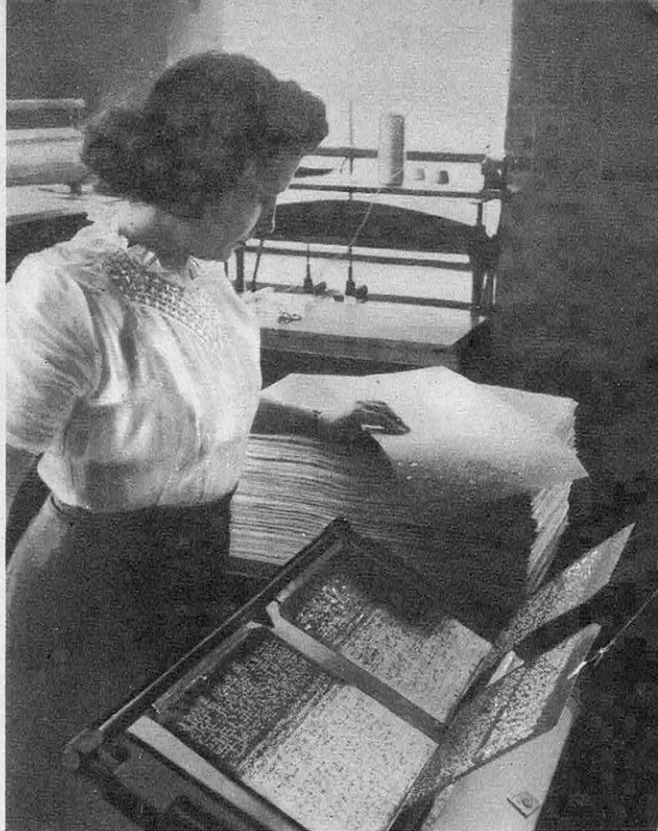
• Cette machine qui imprime en Braille des deux côtés de la page, tout comme dans l'imprimé ordinaire, deux feuillets à la fois, est manœuvrée par une jeune aveugle.
