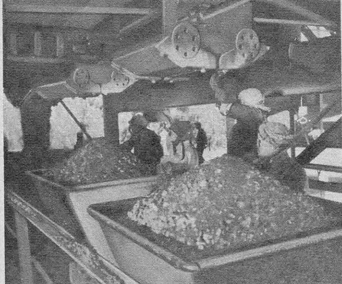
● Les graviers diamantifères sortant des puits de mines sont acheminés par wagonnets à l'usine de traitement.
