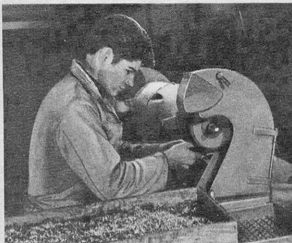
● On les polit sur un tour animé d'une grande vitesse et garni de peau de buffle, de calicot ou de peau de chamouis.
