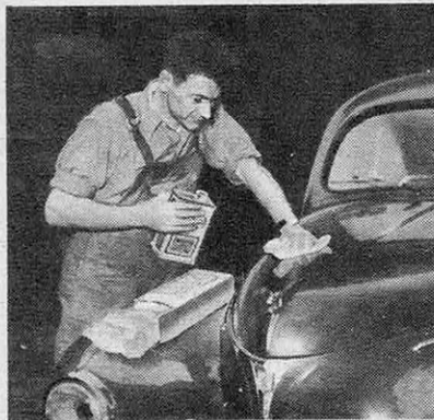
● Après lavage, désoxydage et polissage sont durs, mais indispensables.
