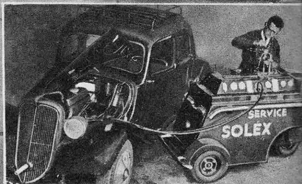
● A la station-service adjointe à l'usine Solex, ce banc d'essai mobile contrôle carburation et allumage.
