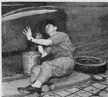
● Un nettoyage complet doit comporter un grattage de l'intérieur des ailes.
