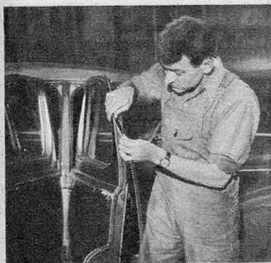
● Vérification des joints de caoutchouc assurant l'étanchéité de la caisse.
