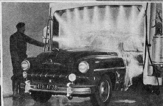
● Afin de gratifier la voiture d'un shampoing, un pont roulant encadre le véhicule et l'inonde d'un détergent.
