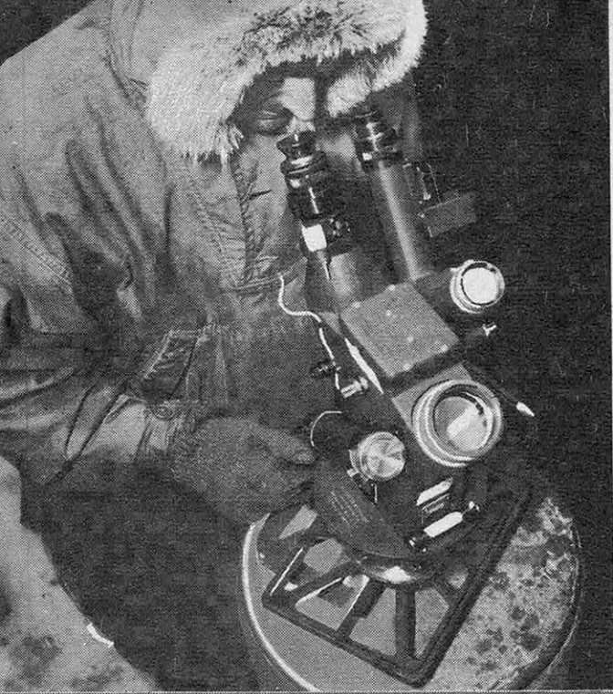
● Ci-dessus, l'astrolabe est en station sur le pilier en béton édifié au poste-observatoire de Port-Martin.
