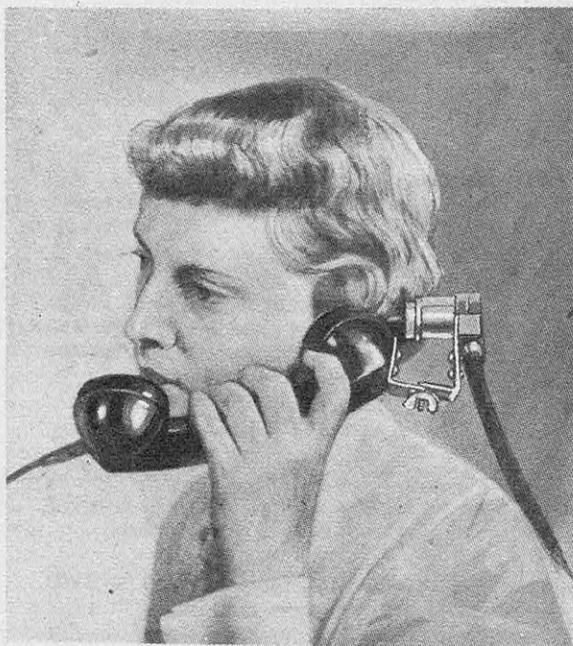
● Les recherches sur le bruit intéressent de nombreux domaines. Ici, l'appareil branché sur l'écouteur permet, pour une meilleure utilisation du téléphone, d'étudier les pressions que peut exercer le son dans l'oreille.
