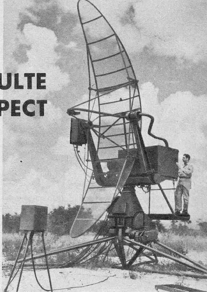
● Cette antenne de radar est animée d'un balancement assez rapide qui encadre la zone nuageuse étudiée. Les échos renvoyés par le nuage traduisent sa structure et son évolution sur l'écran d'un récepteur.
