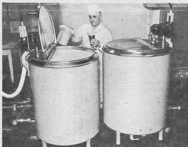
● Pour certains laits spéciaux, on procède à l'addition de vitamines dans des récipients soigneusement dosés où un fouet rotatif assure un mélange homogène.
