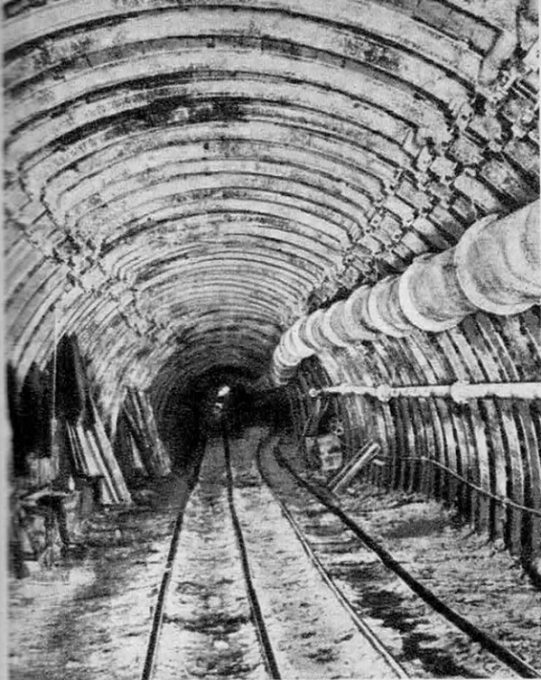
● Les galeries amenant le charbon aux puits permettent la circulation de trains de 40 à 50 berlines, remorqués à 20 km/h par des locomotives à mazout ou électriques.
