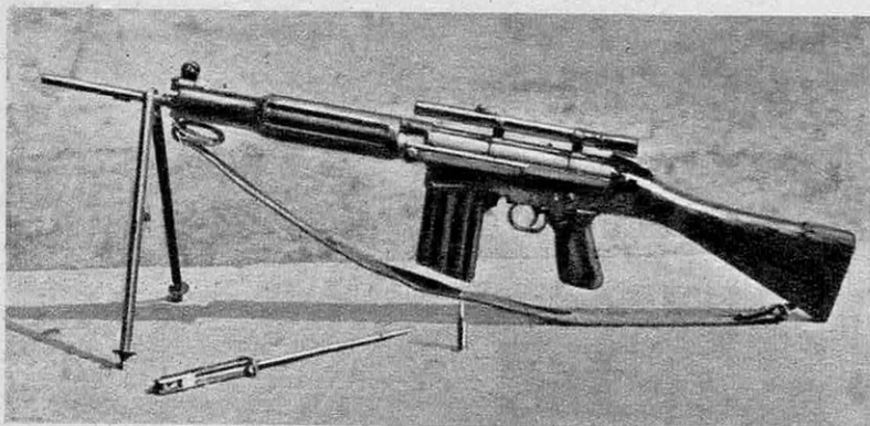
← L'équivalent belge du 280 rifle anglais : de même calibre, il est aussi muni d'un viseur optique pour le tir ajusté ; ses chargeurs ont l'avantage d'être interchangeables avec ceux du fusil mitrailleur.
