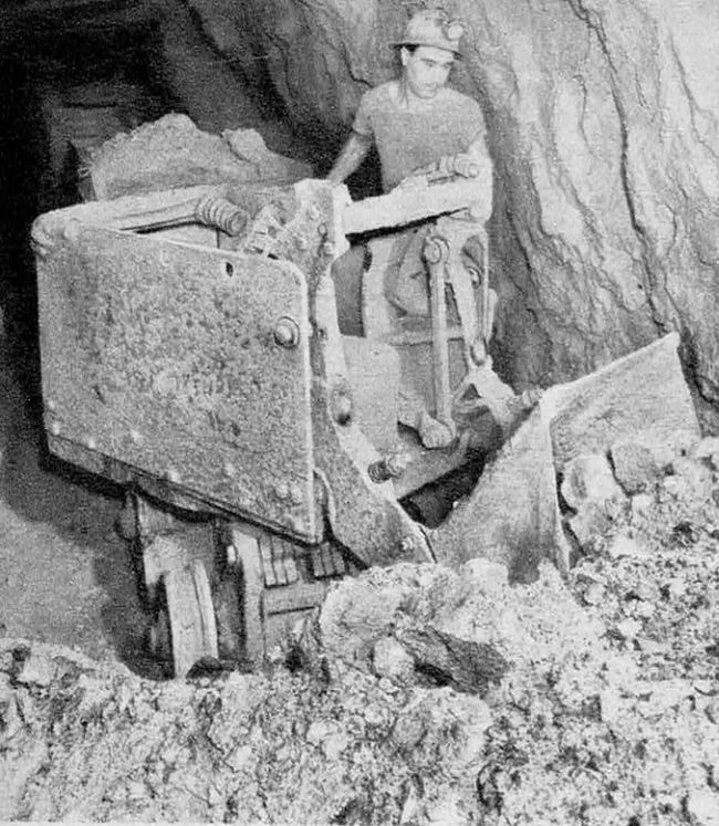
● Cette petite pelle mécanique, de faible encombrement et facilement manœuvrable, fait le travail de quatre hommes. Elle peut soulever des pierres pesant jusqu'à 20 kg.
