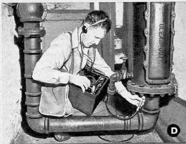
● L'Audigage, basé sur la résonance des ultrasons, donne l'épaisseur des métaux comme leurs défauts.
