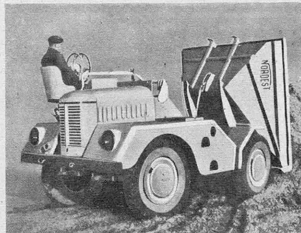
● Avec le dumper « Nordest » à quatre roues directrices et motrices, le conducteur est toujours placé face à son travail.
