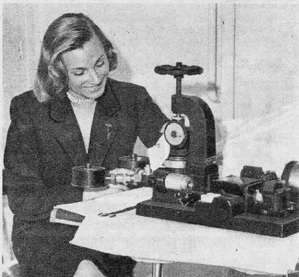
ÉCLATOMÈTRE. — Le tissu, tendu entre des mâchoires annulaires, est soumis, jusqu'à éclatement, à une pression d'huile qui s'exerce sous une membrane souple.
