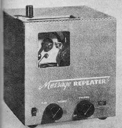
MACHINE A FAIRE L'ARTICLE. On a enregistré sur bande un message de 2 mn qui est répété autant qu'on le veut (Mohawk Bus. Mach.)
