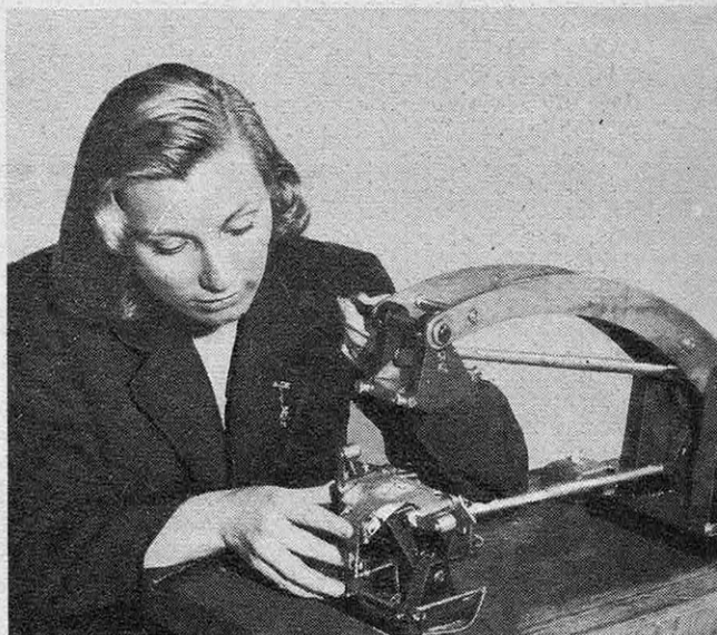
ESSAI D'USURE DE TISSU. — Cet appareil est l'abrasimètre du chanoine Pinte. Il assure l'usure tissu contre tissu sous une pression nettement déterminée.
