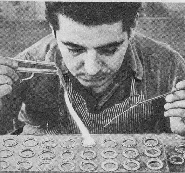
5 Bien qu'effectués à la main, les assemblages se font en série, comme ici la soudure au chalumeau de motifs rapportés sur des anneaux.
