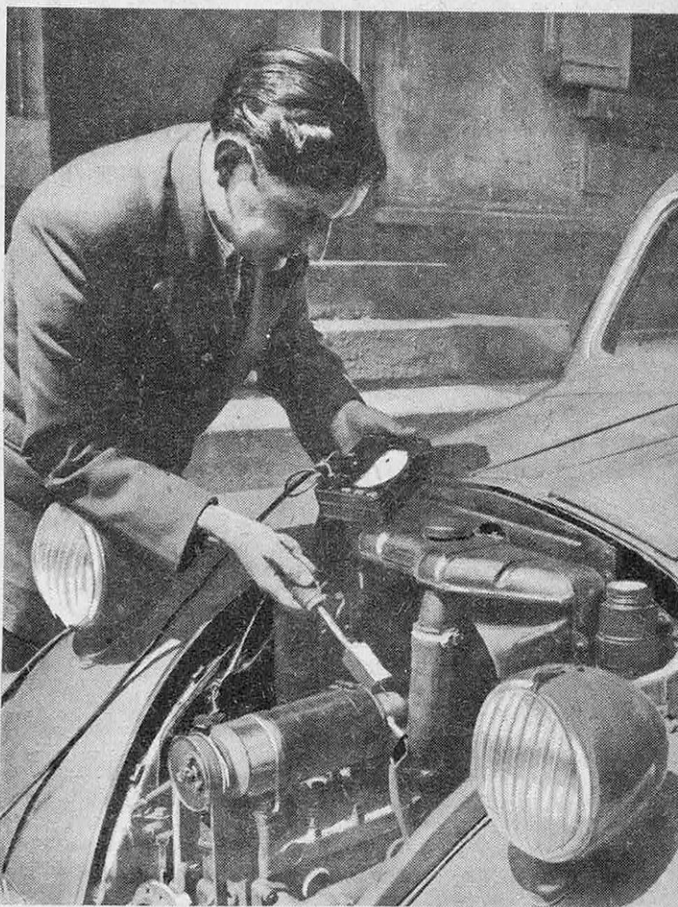
Ici, M. Jacques Jarret étudie les vibrations des différents organes d'un moteur à l'aide d'une sonde spéciale et d'un ohmmètre. L'aiguille de la sonde est montée sur une masselotte qui remplace l'équipage mobile du pick-up. Cette sonde sert à déceler toutes les vibrations anormales.
