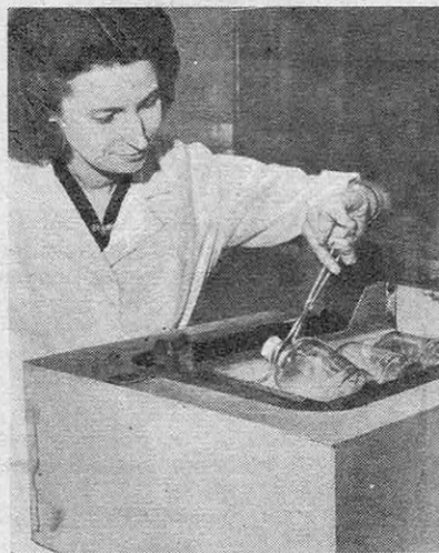
CONGÉLATION : les flacons de verre neutre contenant du plasma sont alors placés pour congélation dans un appareil à carboglace (glace carbonique) où la température est maintenue à - 75° C. Cette basse température est obtenue grâce à la réalisation d'un vide poussé.
