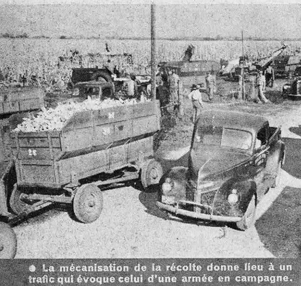
● Ces machines récoltent sur quatre rangées à la fois les épis de maïs qu'elles chargent sur une remorque.
