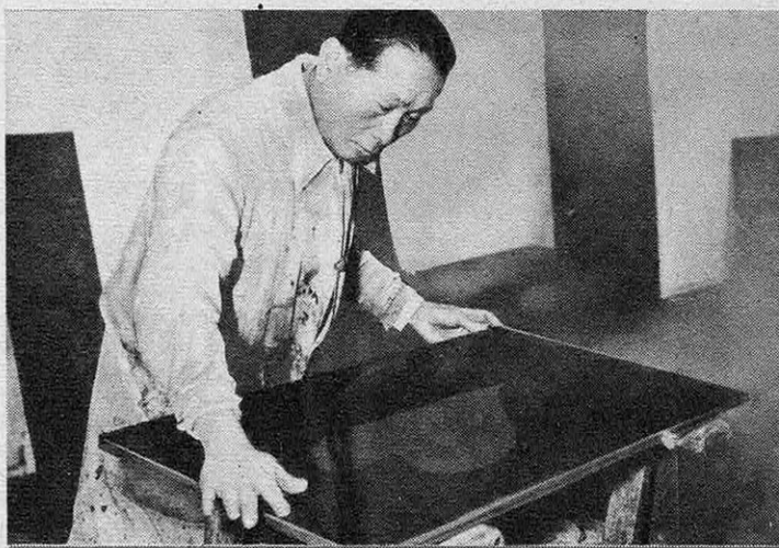
6 Le dernier polissage s'effectue avec de la cendre de corne de cerf passée avec la paume de la main.
