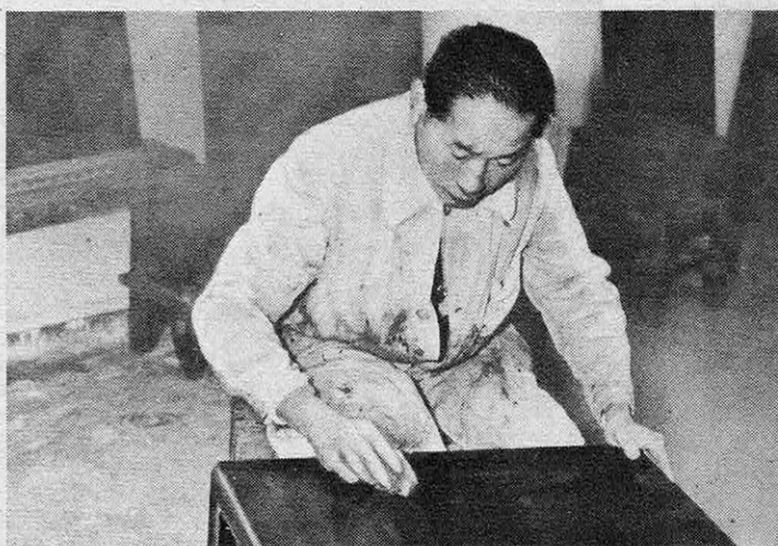
4 Chaque couche de laque est poncée très soigneusement; les ponces employées sont à base de charbon.
