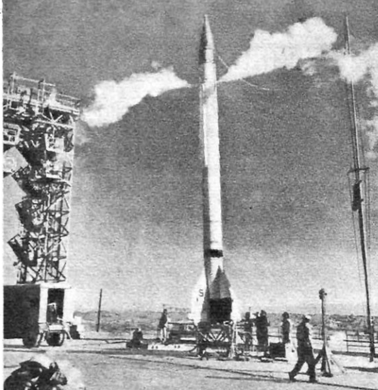
● Les vapeurs s'échappant des événements dénotent que les réservoirs d'oxygène sont pleins. Il n'y a plus qu'à dégager l'aire de départ.
