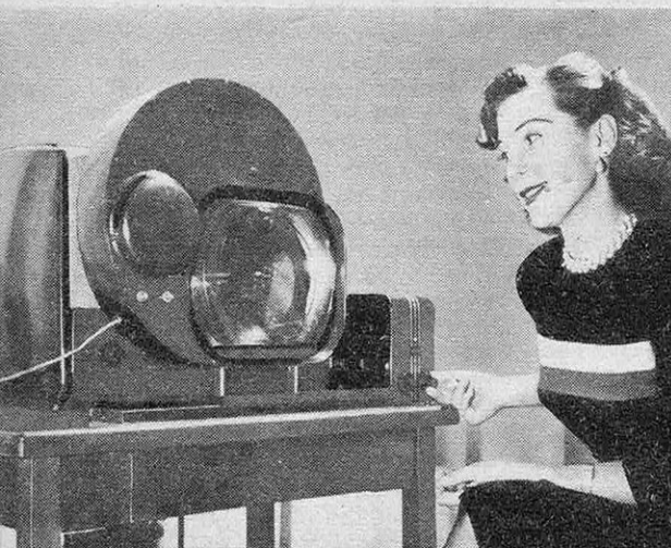
● Cet appareil permet d'adapter à la réception des couleurs les récepteurs de télévision ordinaires.
