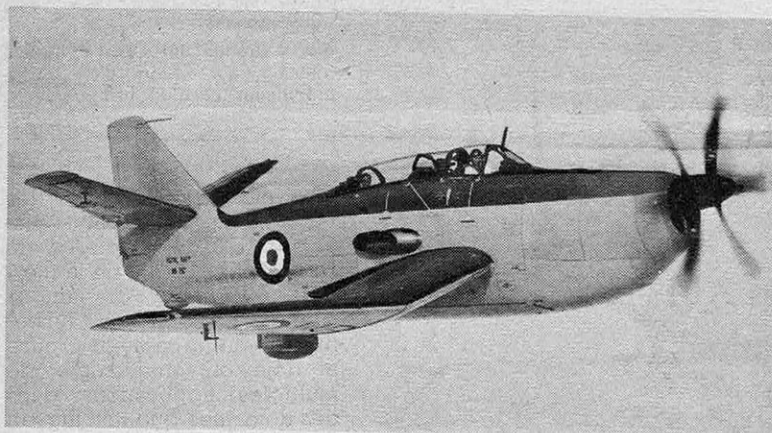
◀ Le chasseur de sous-marins britannique Blackburn YB-1, équipé d'un turbopropulseur Armstrong Siddey « Double Mamba », de 2 540 ch. On aperçoit une des deux tuyères d'échappement qui donnent 350 kg de poussée et, sous le fuselage, le « Radome », radar qui sert au repérage des sous-marins.
