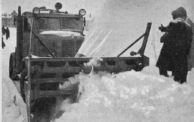
● Camion chasse-neige canadien muni de fraises à axe horizontal : une turbine projette la neige latéralement.
