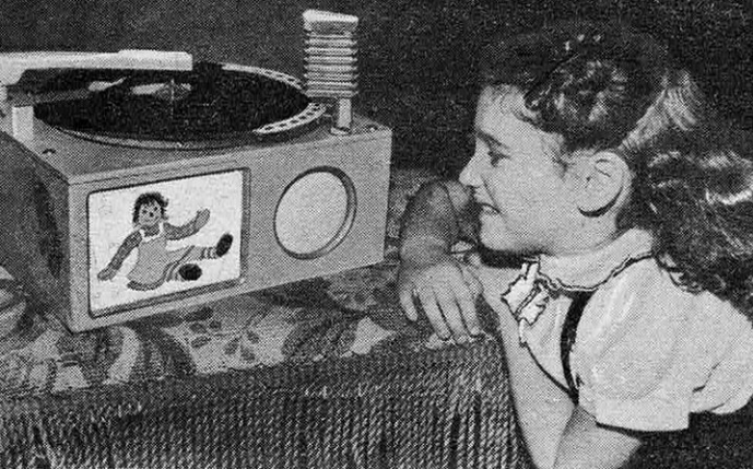
● Phonographe synchronisé avec le déroulement d'une pellicule en couleurs de 16 mm. L'image projetée sur l'écran latéral change toutes les 11 s. Durée : 3 mn environ.
