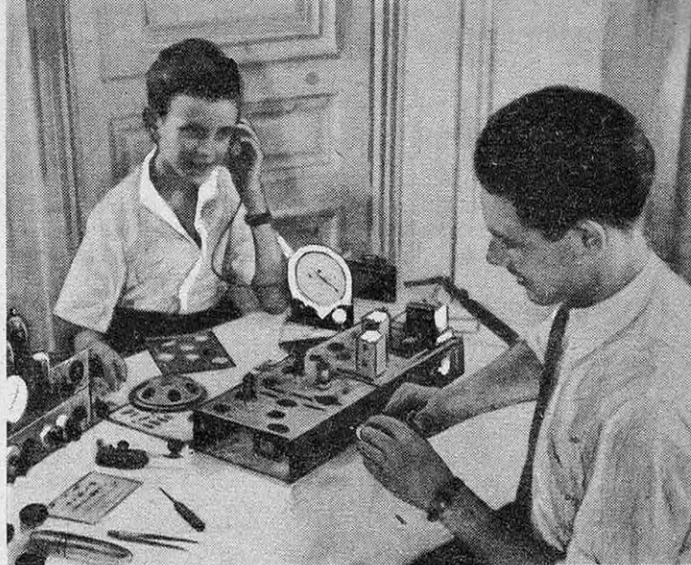
● Avec celui-ci on réalise, au moyen de pièces interchangeable, des montages de radio qui vont d'appareils fort simples jusqu'aux postes compliqués (Câblo-Radio).
