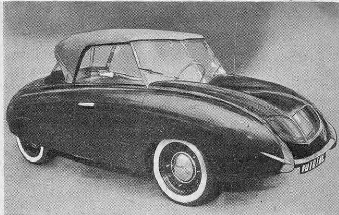
HENRI LABOURDETTE. Prototype de cabriolet 3 places à visibilité intégrale : pare-brise Vutotal, capot avant déprimé au centre, large baie de custode ; la caisse mono-coque est équipée avec un moteur de 4 ch Renault.
