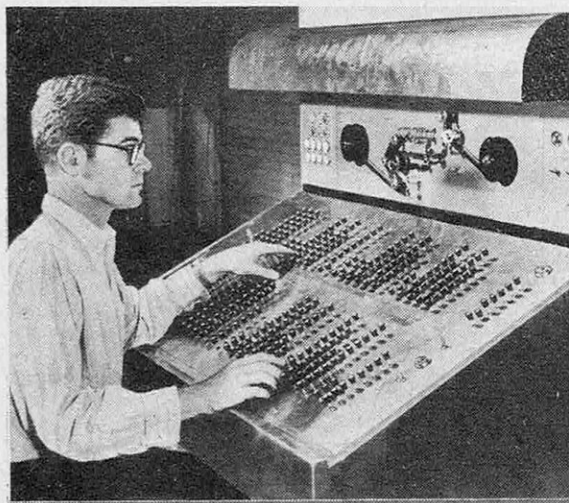
Le tableau de codage et les bobines sur lesquelles passe le film où s'enregistrent les opérations.
