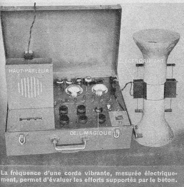
Un oscillographe mesure la vitesse du son dans une dalle, d'où on déduit ses caractéristiques mécaniques.
