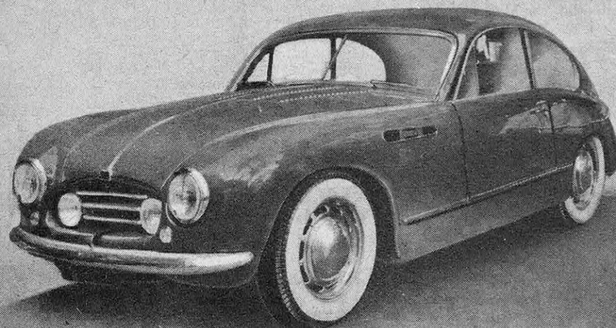
Coach grand sport DB type 2; moteur Citroën 11 ch spécialement équipé; roues avant motrices. Carrosserie Antem légère. Vitesse maximum : 160 km/h.
