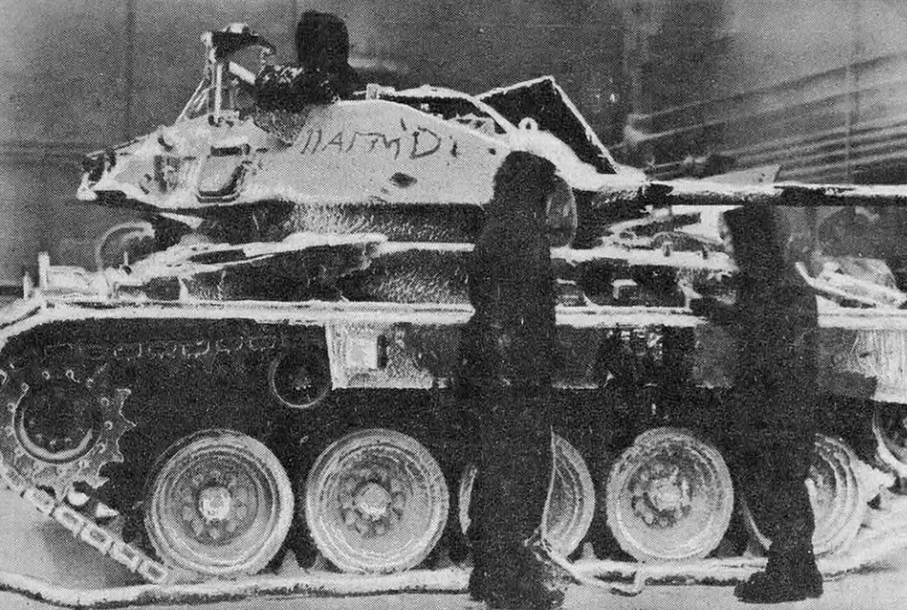
Dans le hall climatique d'Eglin Field, un char d'assaut recouvert de givre artificiellement produit au cours d'une séance prolongée d'exposition à une température de -55^{\circ}\text{C} .
