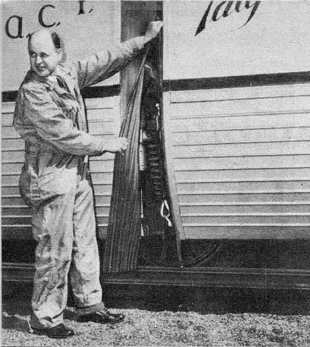
Au dehors et au dedans, des fermetures « éclair » assujettissent les soufflets réunissant les unités du train.
