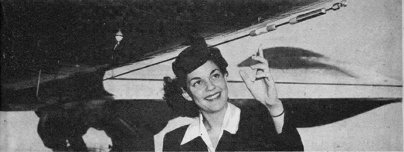
Fig. 1 : Antenne d'avion munie d'isolateurs blindés dont le rôle est d'assurer la protection de ses extrémités et de son raccordement avec la prise d'antenne contre les décharges électrostatiques. (Dayton Aircraft Products.)
