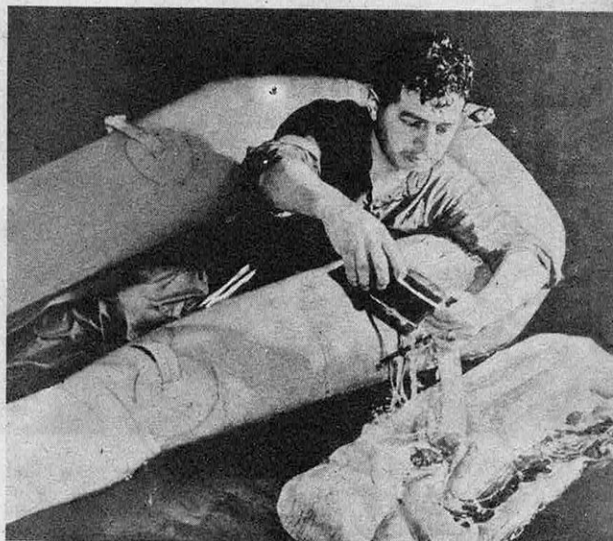
Fig. 7 : Le naufragé, après avoir étalé le ballon sur l'eau, y introduit un peu d'eau qui sera absorbée par l'éponge synthétique. Il videra l'excès d'eau et gonflera le ballon en soufflant à la bouche. Le ballon flottera sur l'eau, fixé au canot par une cordelette de nylon. (U. S. I. S.)
