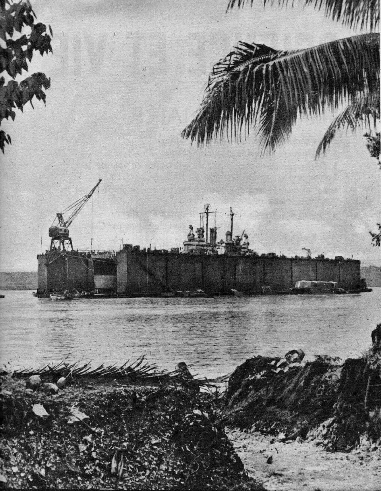
Fig. 1 : Un dock flottant démontable « A. B. S. D. » de la marine américaine réparant un croiseur léger du type « Cleveland » dans un archipel du Pacifique que les États-Unis ont utilisé comme base avancée pendant la dernière guerre.
