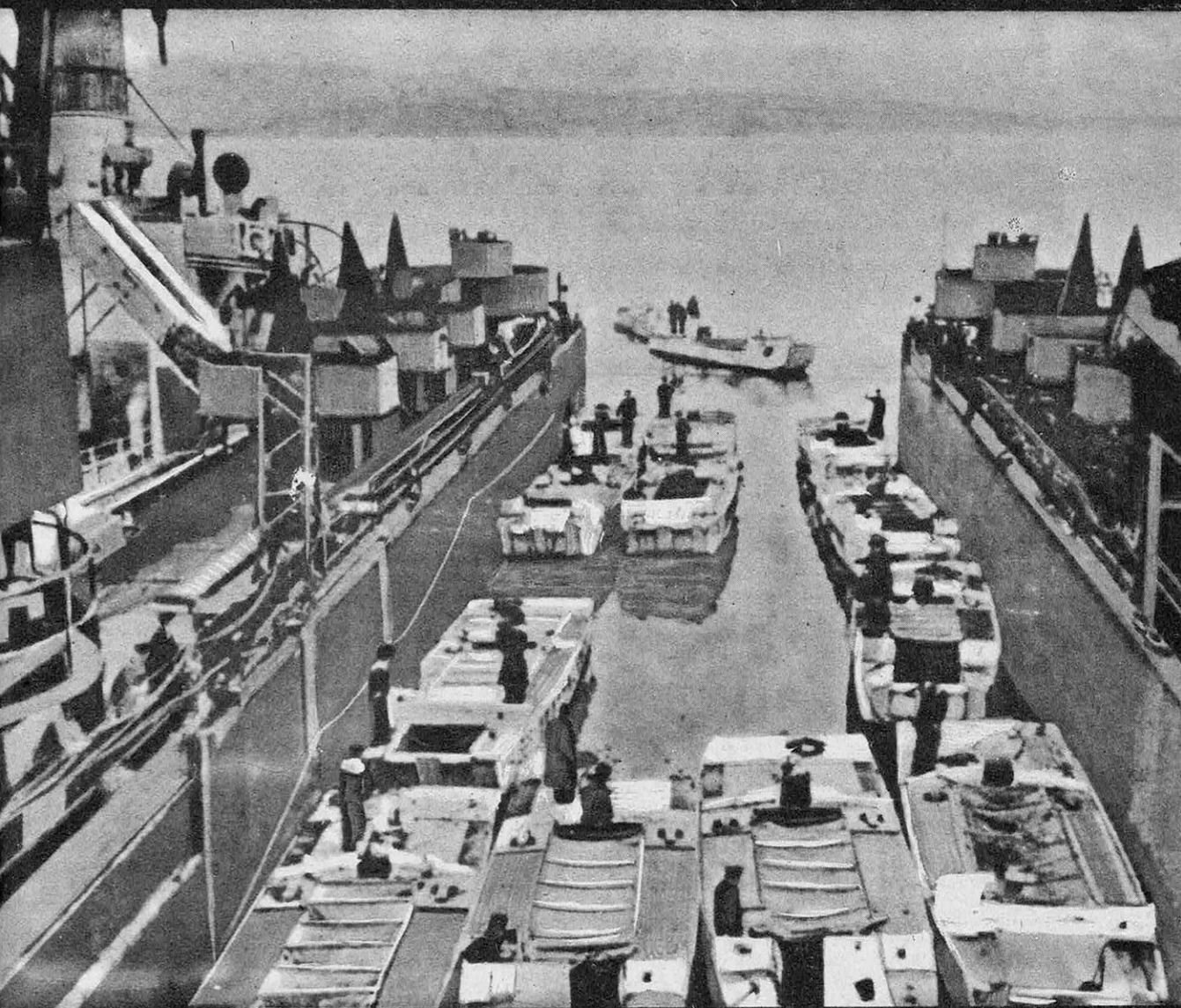
Fig. 8 : A l'arrivée en vue du point de débarquement, la cale sèche du L. S. D. est remplie d'eau et les embarcations d'assaut (L. C. A. et L. C. V. P.) se libèrent par leurs propres moyens avec la plus grande rapidité.
