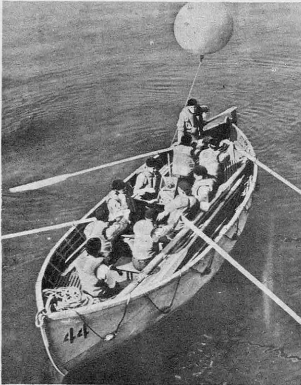
Fig. 2 : Ce canot de sauvetage parachuté contient un poste émetteur radio dont l'antenne va être montée à une centaine de mètres par un ballon gonflé d'hydrogène au moyen d'une pastille d'hydrure de lithium. L'émission des signaux de détresse est automatique ; leur portée dépasse 1 500 km. (U. S. I. S.)
