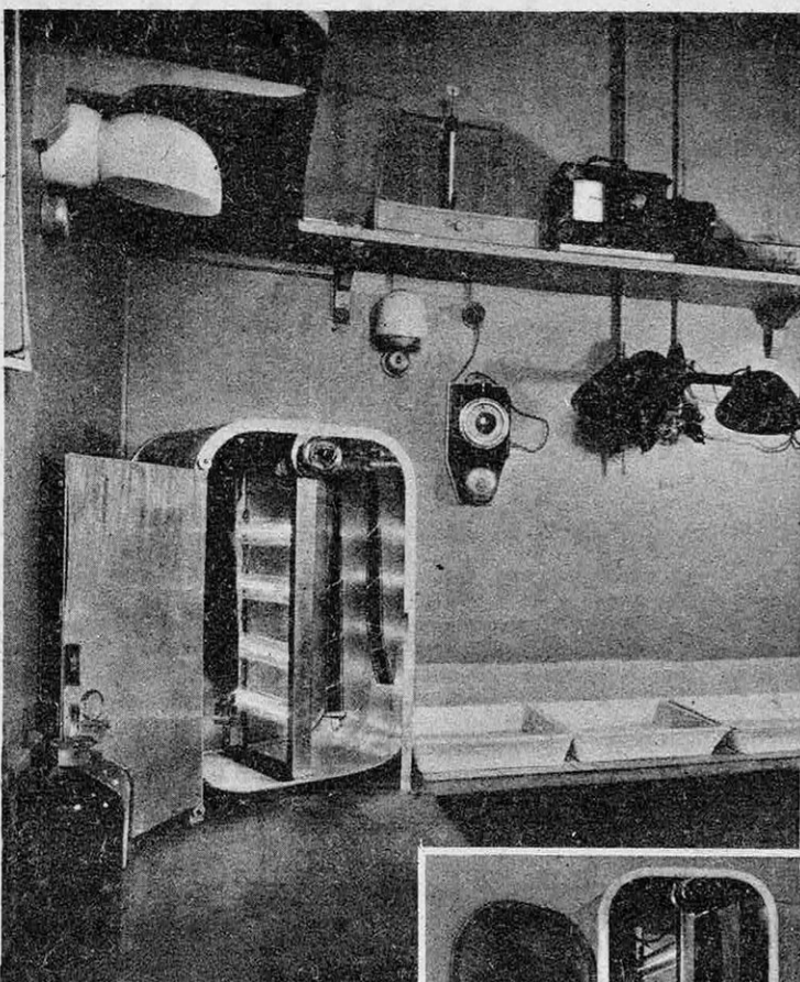
FIG. 2 ET 3. — ÉTUVES D'AMATEUR (CI-DESSUS) ET POUR PROFESSIONNEL (CI-CONTRE) POUR LE SÉCHAGE RAPIDE DES FILMS PAR RAYONS INFRAROUGES
