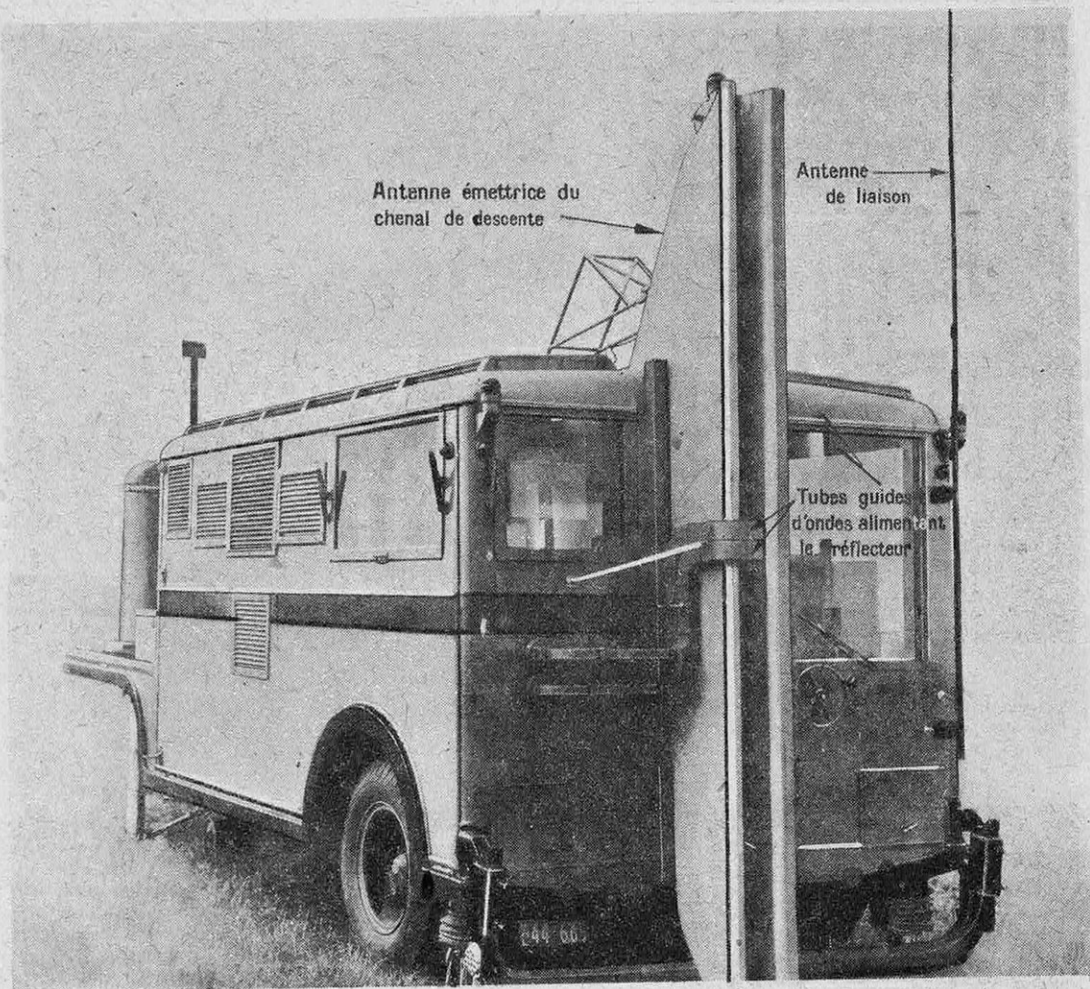
FIG. 11. — L'ÉMETTEUR DE DESCENTE DU SYSTÈME D'ATERRISSAGE SPERRY A ONDES ULTRACOURTES
