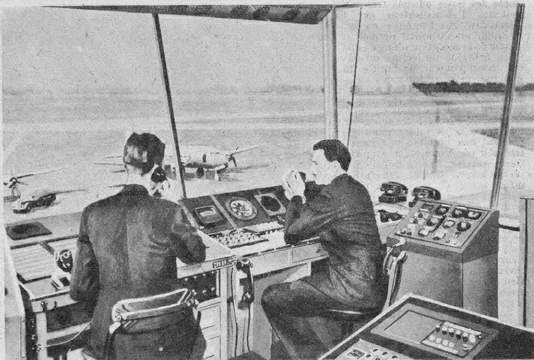
FIG. 6. — LA TOUR DE CONTROLE D'INDIANAPOLIS Le pupitre de droite sert à contrôler l'atterrissage aux instruments.
