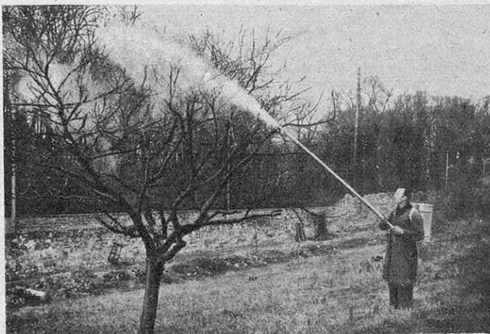
FIG. 2. — POUDREUSE ÉLECTRIQUE EN MARCHÉ, ÉQUIPÉE D'UNE LANCE POUR LE TRAITEMENT DES ARBRES FRUITIERS
