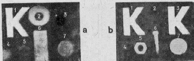
FIG. 5. — COMPARAISON DE LA NEUTROGRAPHIE ET DE LA RADIOGRAPHIE D'UN CERTAIN NOMBRE DE CORPS (KALLMANN ET PETER)
