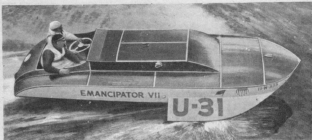
FIG. 6. — LE CANOT AMÉRICAIN « EMANCIPATOR VII », A COQUE EN TROIS POINTS, GLISSE À LA SURFACE DE L'EAU À PLUS DE 80 KM/H AVEC UN MOTEUR DE 4 L DE CYLINDRÉE
