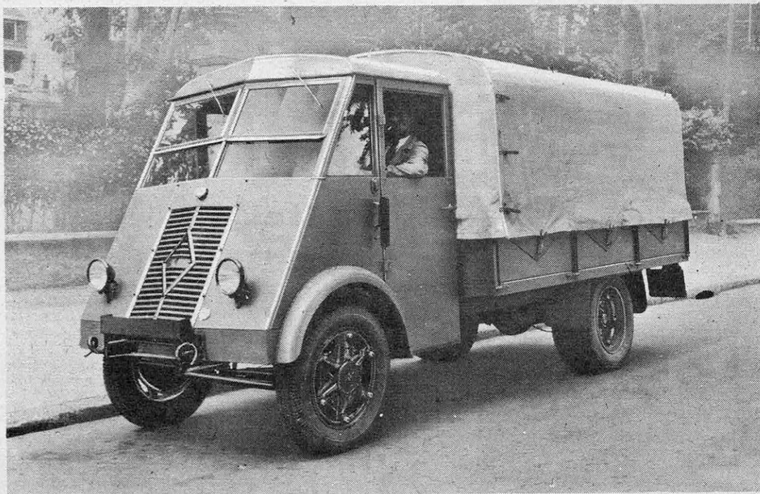
FIG. 4. — LE CAMION RENAULT 2 T A PLATEAU SURBAISSÉ
