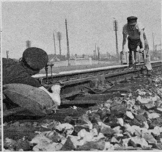
FIG. 9 ET 10. — MESURE DU NIVELLEMENT A L'ÉTAT STATIQUE
