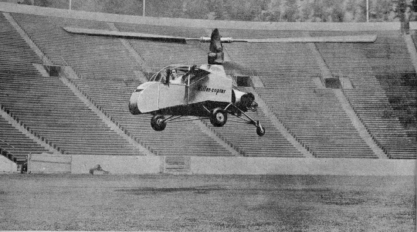
FIG. 3. — L'« HILLER-COPTER I », HÉLICOPTÈRE A DEUX HÉLICES TOURNANT EN SENS CONTRAIRES
