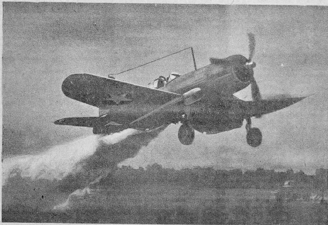
FIG. 8. — ESSAI DE DÉCOLLAGE D'UN CHASSEUR EMBARQUÉ DE LA MARINE AMÉRICAINE AVEC L'AIDE DE FUSÉES Les fusées donnent, suivant les caractéristiques des avions et leur état de chargement, une réduction de 30 à 60 % de la longueur de décollage. Le chasseur est ici un Vought-Sikorsky « Corsair ».
