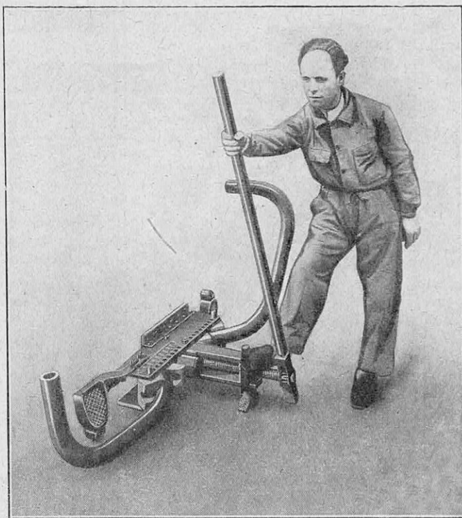
LA CINTREUSE MINGORI PERMET A UN OUVRIER DE CINTRER DANS N'IMPORTE QUEL PLAN DES TUBES DE 50×60 A 102×114 MILLIMÈTRES EN QUELQUES MINUTES
