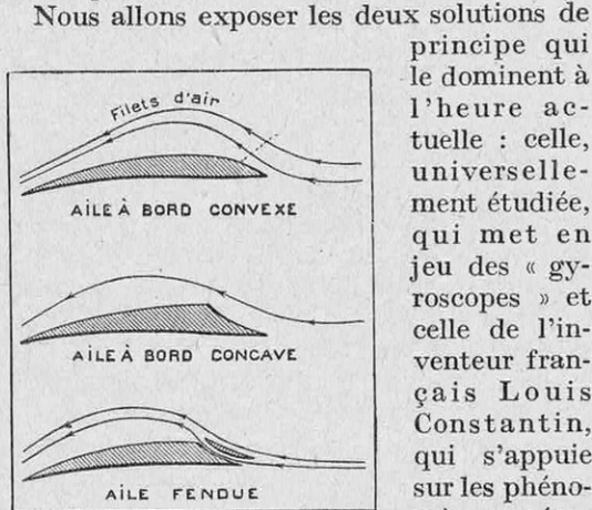
FIG. 1. — LES MODIFICATIONS THÉORIQUES DU BORD D'ATTAQUE DES AILES QUE M. CONSTANTIN PRÉCONISAIT DÈS 1912
