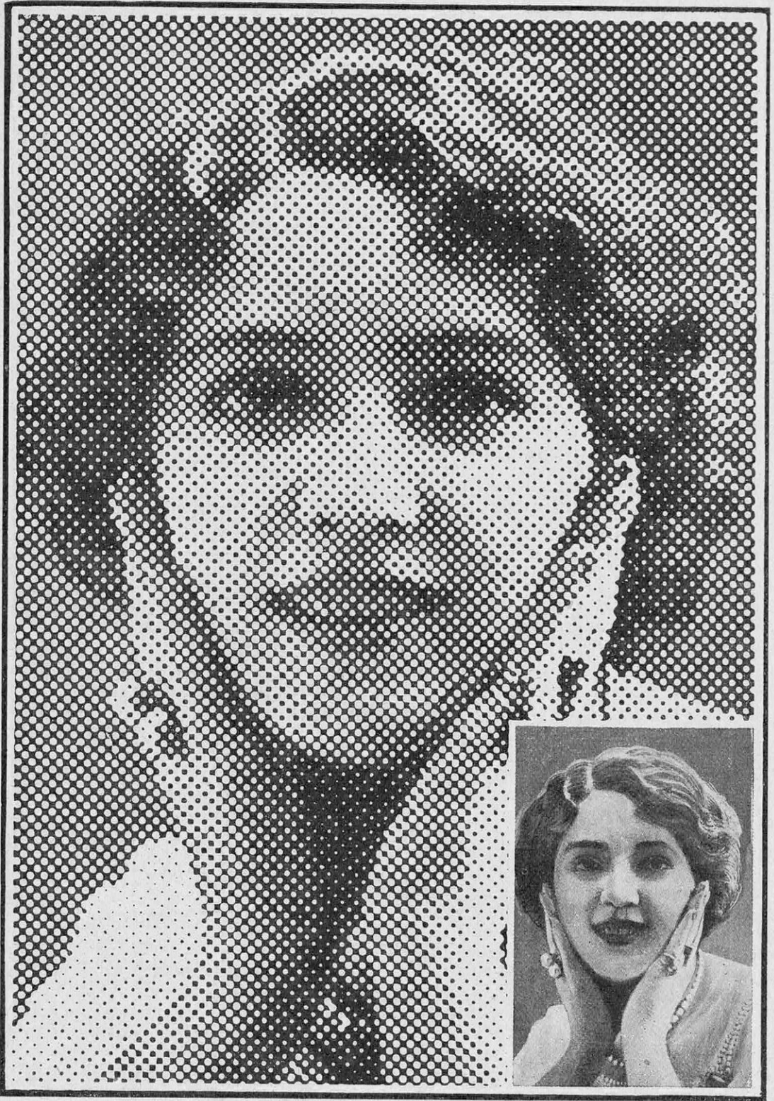
FIG. 7. — VOICI COMMENT APPARAÎT UNE ÉPREUVE DE SIMILIGRAVURE FORTEMENT GROSSIE Il suffit de regarder cette épreuve à une distance convenable pour que les taches, ou plus exactement les points noirs et blancs, donnent l'impression des ombres et des lumières comme sur la photo placée en bas et à droite, obtenue avec la trame 120 employée dans La Science et la Vie.
