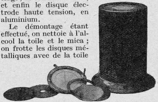
L'OZONISEUR MONTÉ (A DROITE) ET LES PIÈCES DÉTACHÉES (A GAUCHE)
