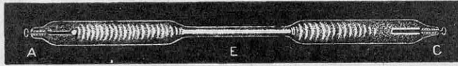
FIG. 6. - AUTRE REPRÉSENTATION DU MÊME PHÉNOMÈNE Cette reproduction photographique montre clairement les stries de la figure 5. L'étranglement E est un tube fin (tube capillaire), où la lueur est beaucoup plus intense.
