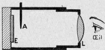
FIG. 11. — LE SPINTHARISCOPE, FONDÉ SUR LA LUMINESCENCE, PERMET DE VOIR LES ATOMES
