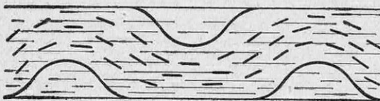
FIG. 2. — COMMENT ON OBTIENT LES EFFETS D'IRISATION DE LA NACRE ARTIFICIELLE
