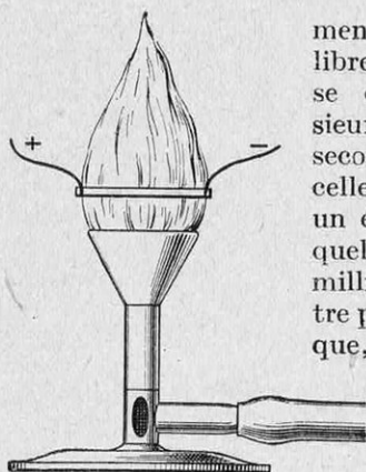
FIG. 5. — UN BATONNET DE MAGNÉSIE, CHAUFFÉ PAR UN BEC DE GAZ, DEVIENT CONDUCTEUR, ET LE COURANT ÉLECTRIQUE QUI LE TRAVERSE L'ÉLÈVE À L'INCANDESCENCE. C'EST LE PRINCIPE DE LA LAMPE NERNST
