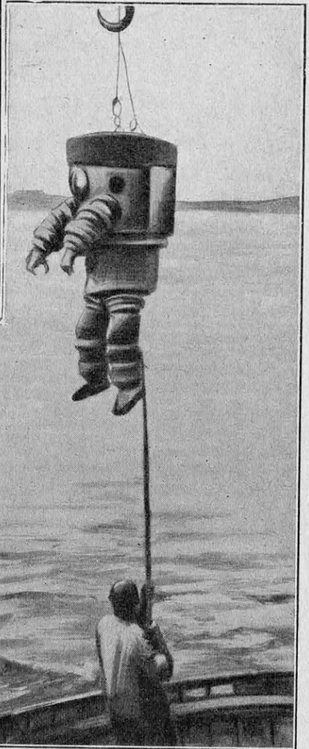
CE SCAPHANDRE PERMET DE DESCENDRE A UNE PROFONDEUR DE 40 MÈTRES
