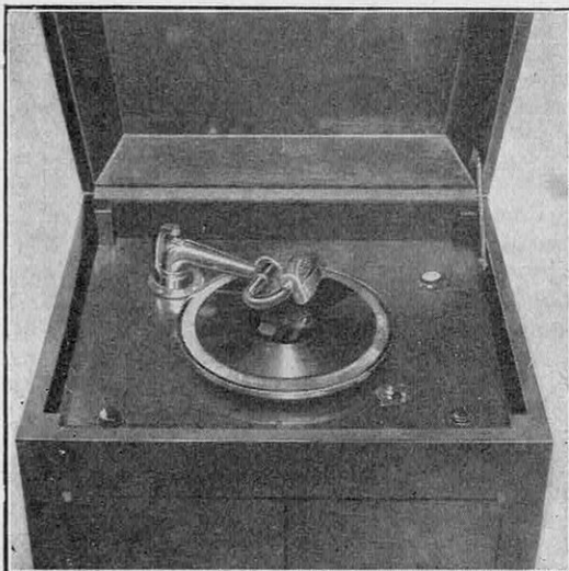
VUE DE DESSUS DU MEUBLE CONTENANT L'AMPLIFICATEUR PHONOGRAPHIQUE ET MONTRANT LE DISQUE, LE « PICK-UP » ET, A DROITE ET A GAUCHE, LES DEUX BOUTONS DE MANŒUVRE
