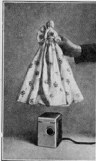
FIG. 11. — ... DONT LE FAISCEAU, REÇU PAR UN RÉCEPTEUR MINUSCULE DISSIMULÉ SOUS LA MOUSSELINE D'UNE ROBE DE POUPEE, FORMERA UN « BARRAGE »
