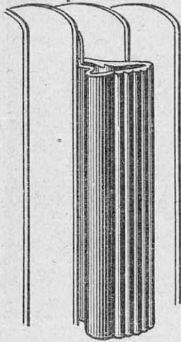
COMMENT ON PLACE LE RÉCIPIENT EN TERRE POREUSE SUR UN RADIATEUR
