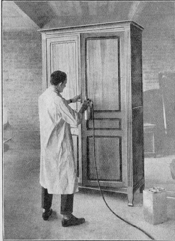
COMMENT ON APPLIQUE LE « CIRÉ NITROLAC » AU PISTOLET, POUR RENDRE LES MEUBLES INALTÉRABLES A L'EAU
